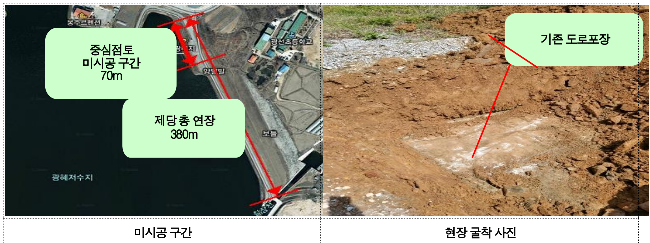
[그림 23] 광혜저수지의 중심점토 미시공 사례
