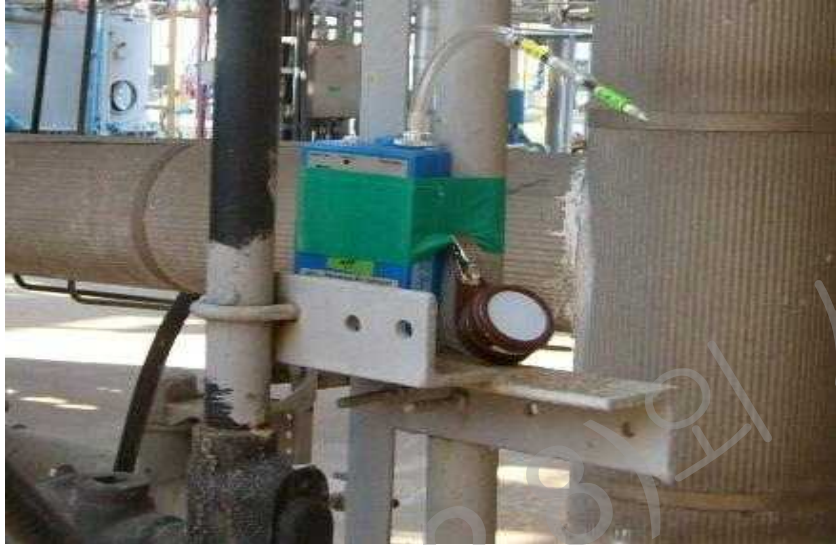
[그림 28] 능동식 및 수동식 시료채취기의 동시설치 가동모습
